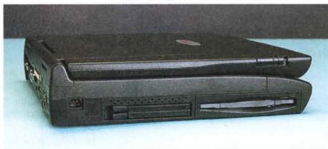
Lato sinistro: il connettore di alimentazione, le porte PCMCIA, e il floppy; il quadratino all'estrema sinistra è la predisposizione per il modem
